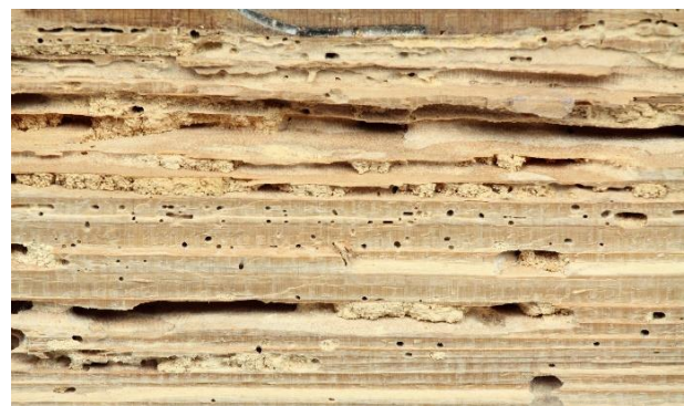
Hout dat sterk aangetast is door houtworm (Afbeelding: suurdongediertebestrijding.nl)
