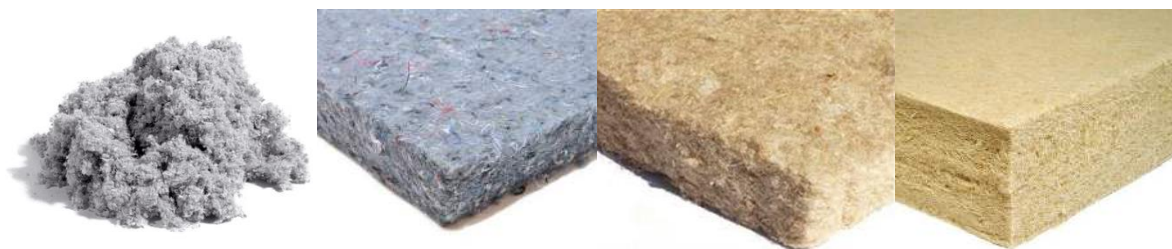
Soepele isolatiematerialen uit hernieuwbare grondstoffen: gerecycleerd papier, gerecycleerd textiel, vlas, hennep (Bron: Isoproc, Metisse, Isovlas, Hempflax)
