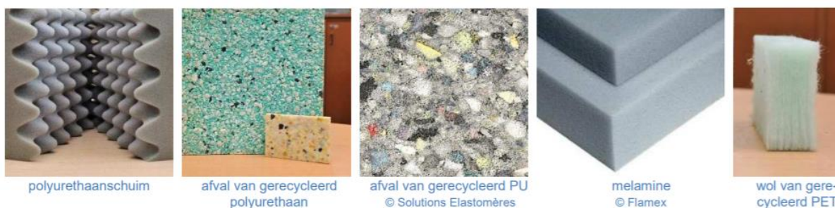
Schuimachtige isolatiematerialen uit synthetische grondstoffen (Bron: Technisch rapport geluid, code van goede praktijk, Leefmilieu Brussel)
