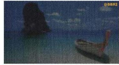
Doek B – Binding: sergé Kleur: zwart - \rho_v : 0,06 Openingsfactor O_f : 3 % Klasse van visueel contact met de buitenomgeving: 2 Zontoetreding \tau_v : 0,03
