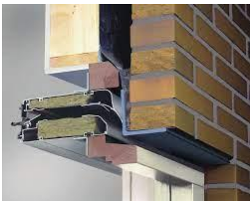
Akoestische ventilatieroosters: optimalisatie van de demping door de weglengte en de dikte van het geluidsabsorberend materiaal te verhogen (illustratie: BUVA)
