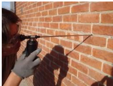
Endoscopisch onderzoek van de spouw, foto Vivixtum
