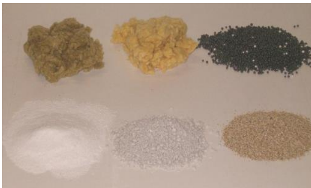
Rotswolvlokken, glaswolvlokken, geëxpandeerde PS- parels, perlietkorrels, silicaatschuimkorrels, vermiculietkorrels, foto Tetra-project 2007-2009 Na-isolatie van spouwmuren – UGent, CIR, Buildwise, Sint-Lukas
