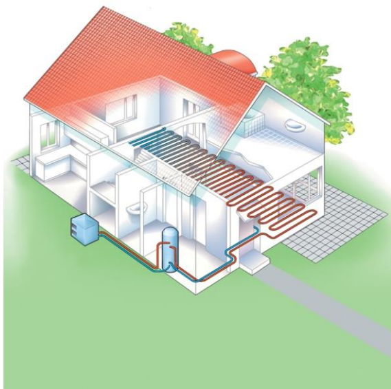
Lucht-waterwarmtepomp, bron: Stiebel Eltron
